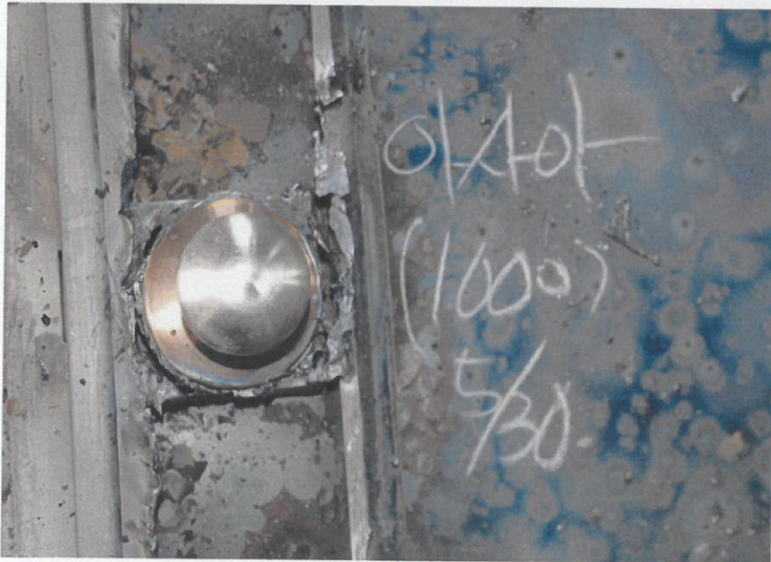
가열종료후 시험체 내부(손잡이 부위) 모습
