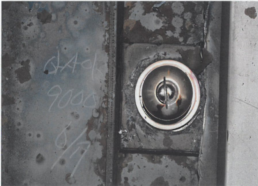
가열종료후 시험체 내부(손잡이 부위) 모습
