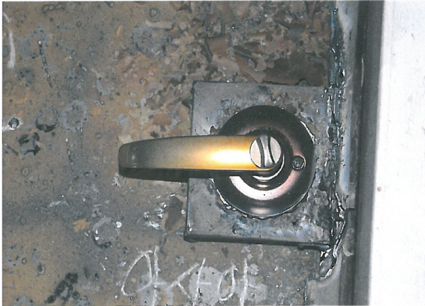
가열 종료후 시험체 내부(손잡이부분) 모습
