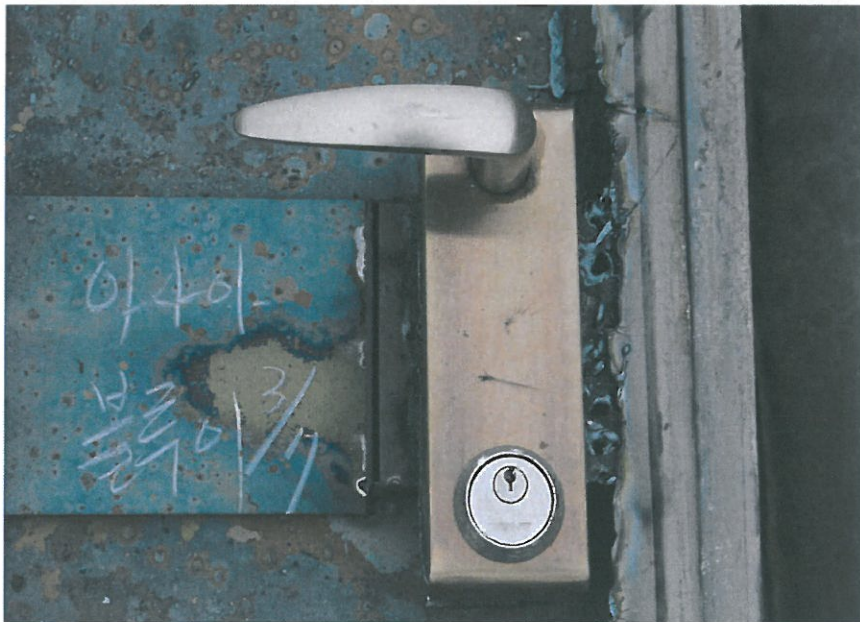
가열 종료후 시험체 내부(손잡이부분) 모습
