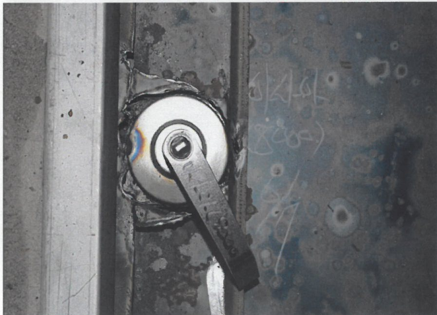
가열종료후 시험체 내부(손잡이 부위) 모습
