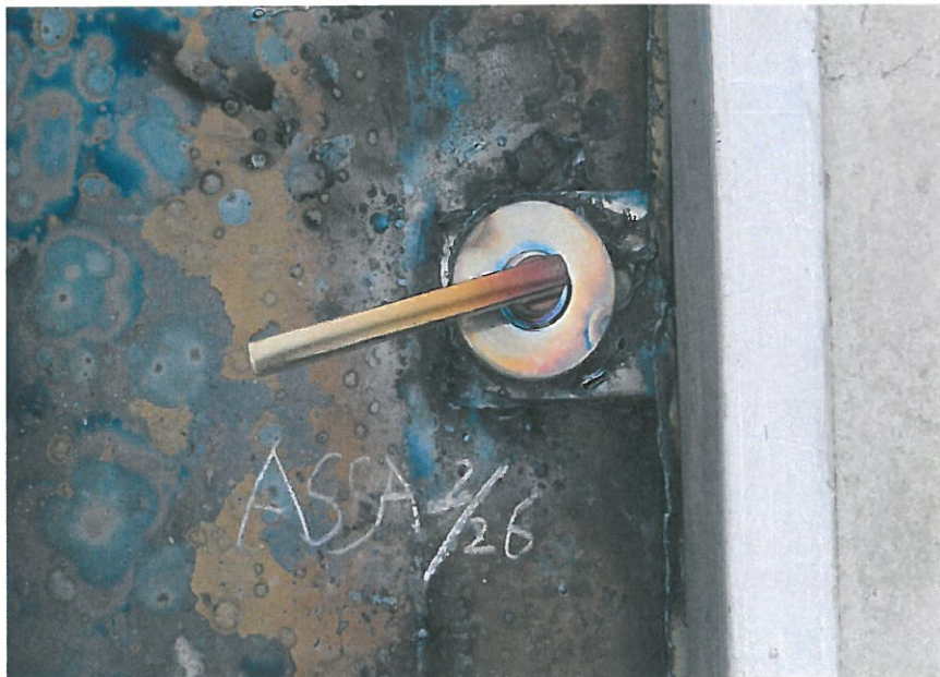
가열 종료후 시험체 내부(손잡이부분) 모습
